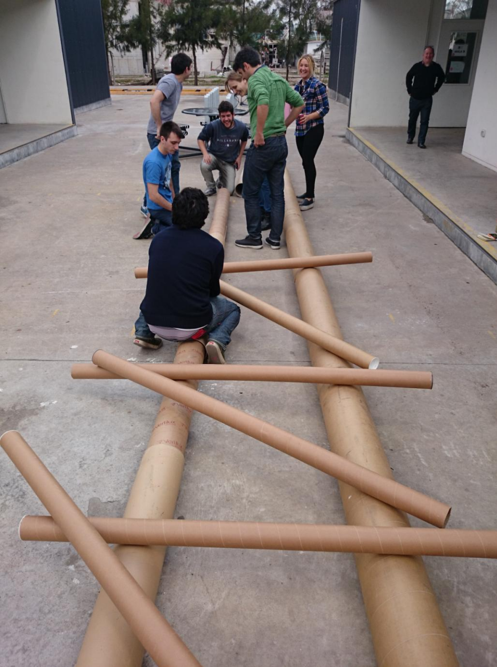
Ensayo de viga reticulada, taller TAU 2015.
